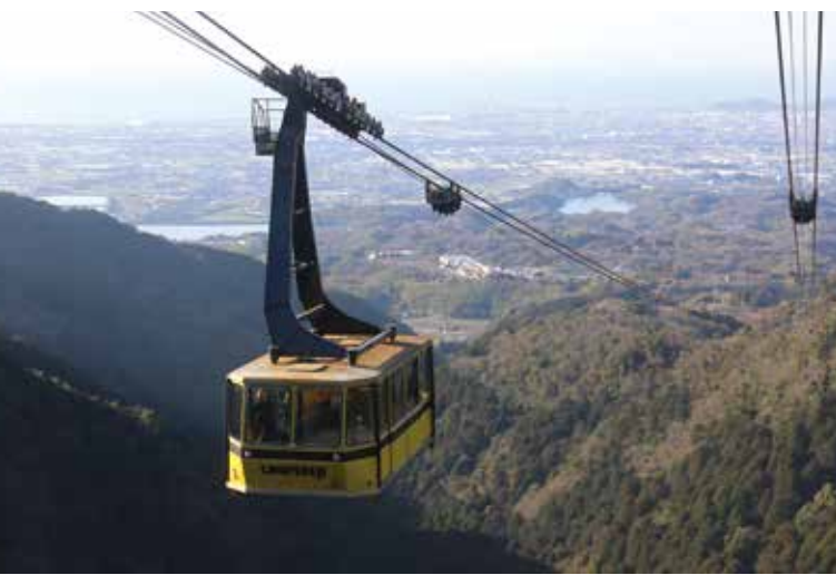
▲ 雲辺寺ロープウェイと第六十六番・雲辺寺 ロープウェイは全長約2600m。かつて「遍路ころがし」と呼ばれていた標高差657mの急こう配を時速36kmで運転する。雲辺寺は、789年に弘法大師が善通寺の建立のため、木材を求めて山に登ったとき、深遠な霊山に心を打たれてお堂を造ったのが起源。
