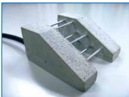
▲ 図6 腐食センサーによる塩化物イオンの浸透深さの測定
