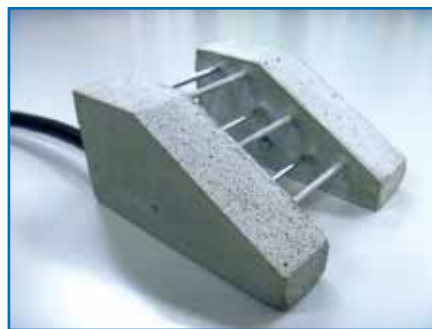
▲ 図6 腐食センサーによる塩化物イオンの浸透深さの測定
