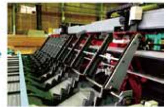
⑥ 自動切断・溶接曲げ・フープ加工
