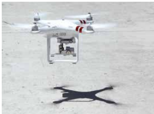
②ドローンによる3次元測量
