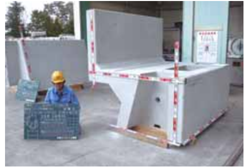
プレキャスト部材 (下部工)
