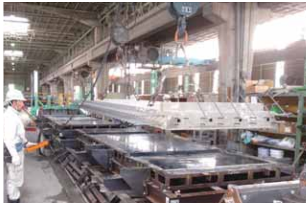
PC床版工場製作状況
