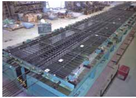
工場製作状況 (上部工)
