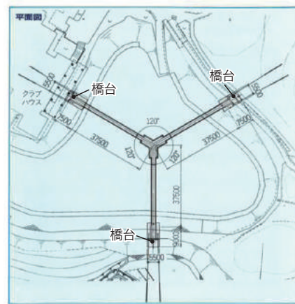
▲ 亀甲橋は三方向からの床版が120度の角度で結ばれている
