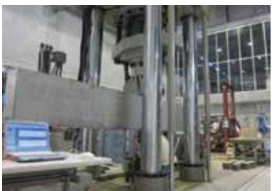
写真-2 10MN 載荷試験機
