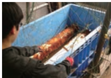
写真-3 RCはりの電食処理
