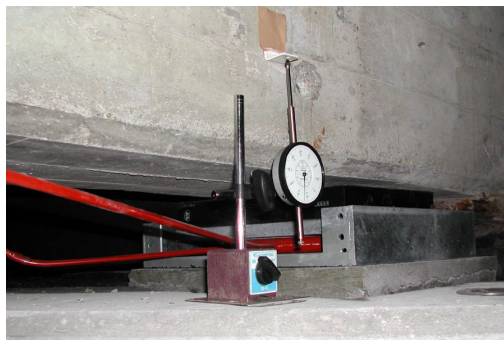
ダイヤルゲージを用いた 変位量の測定例
